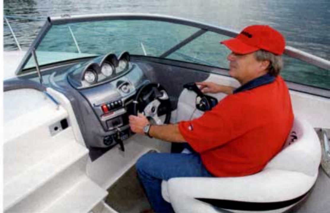
Fahrstand Die dunkle Instrumententafel hält die Spiegelungen in der leicht getönten Windschutzscheibe gering.
