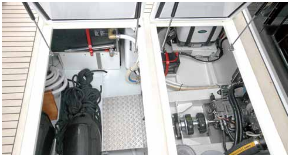
Zwei Bodenluken im Cockpit machen den Weg frei in den achterlichen Bereich des Motorraumes.
