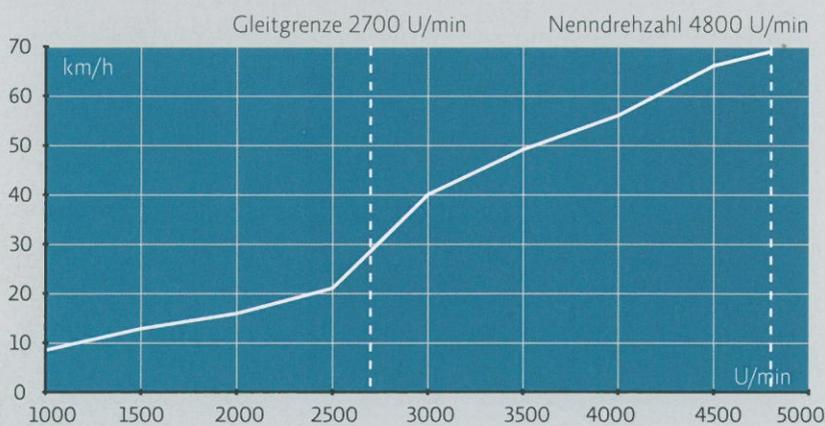
Leerlauf: 600 U/min, Höchstgeschwindigkeit: 69.1 km/h bei 4800 U/min. Gemessen auf dem Zürichsee, mit GPS, 2 Personen an Bord, 3 Bft Wind, aufbauende Wellen.
