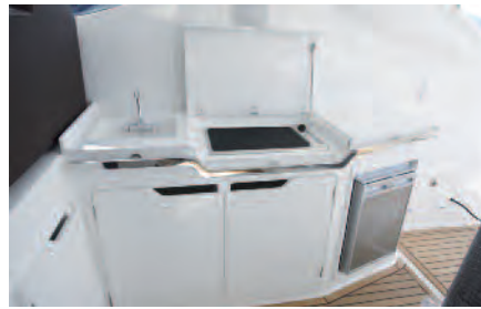
Wetbar im Cockpit mit E-Grill, Spülbecken und Kühlschrank.
