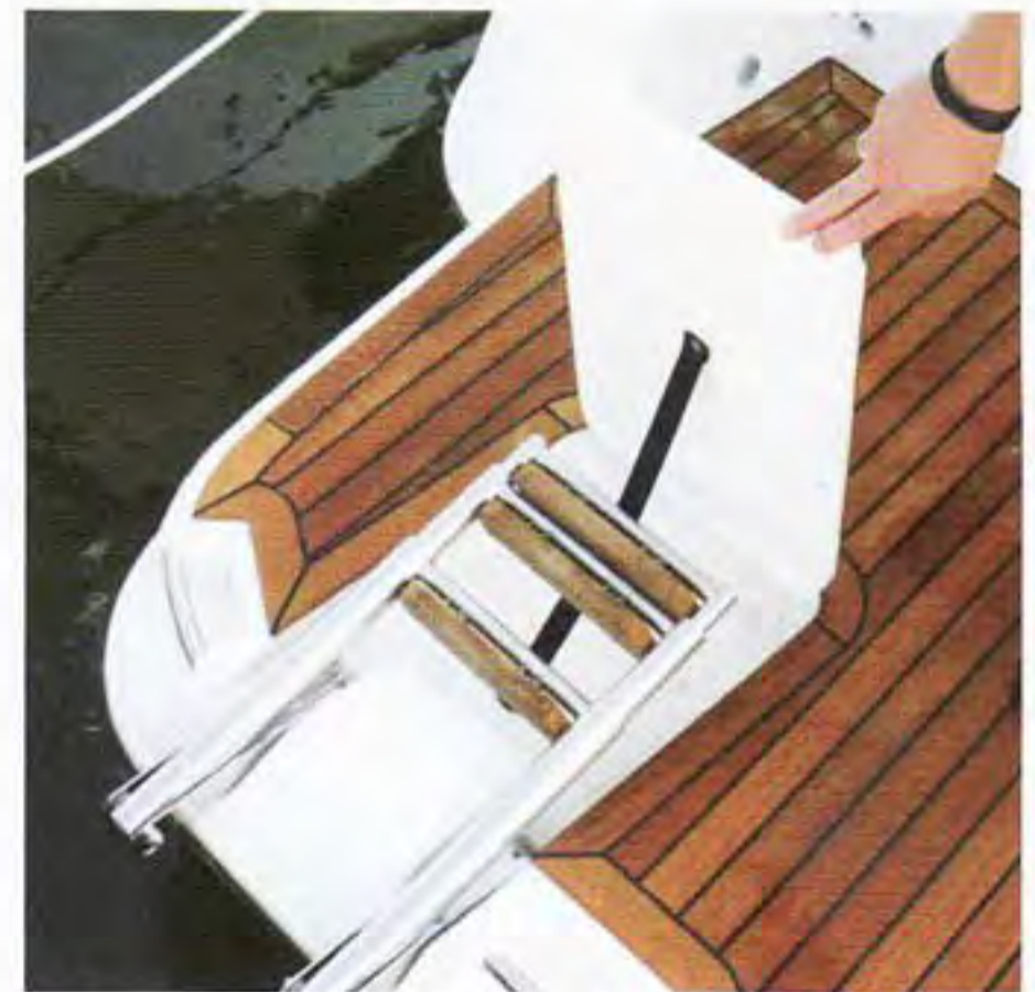
Teleskop-Badeleiter in die Badeplattform integriert.
